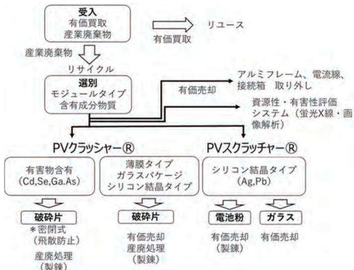
図表 35 PV クラッシャーR、PV スクラッチャーレによる処理フロー
