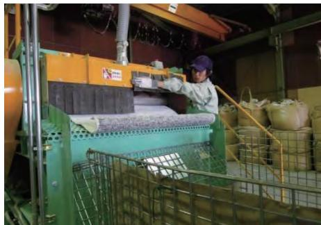
図表 31 破碎機での破碎の様子
