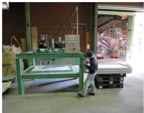
図表 30 アルミフレーム枠外し機
