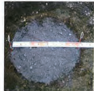
スマートコンパクションで 造出した杭(製鋼スラグ)
