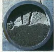
上部に分離した気泡のブロックが形成され、下方には砂が沈殿する
