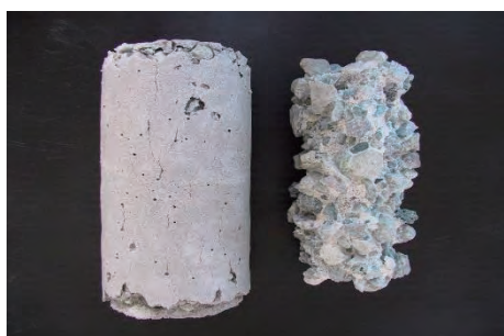
ハイデガス・普通ポルトランドセメント (5%硫酸溶液浸漬 21 週)
