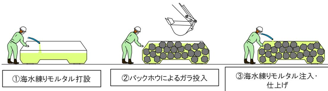
(C)コンクリート用骨材としての利用(適用対象:無筋および鉄筋コンクリート)
