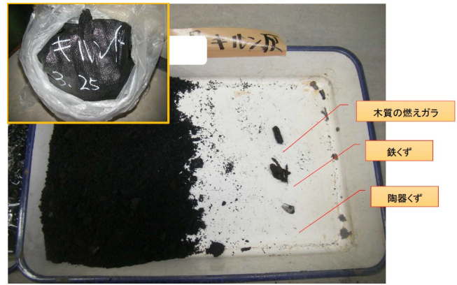
写真2 キルン灰(石巻)の混入不純物
