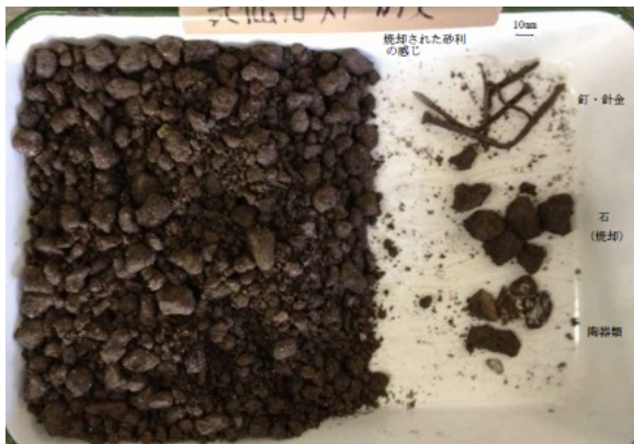
写真5 ストーカー灰(気仙沼)の混入不純物
