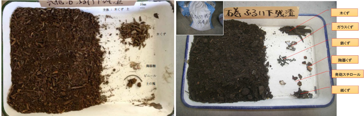
写真7 ふるい下がれき残渣(気仙沼)の混入不純物 写真8 ふるい下がれき残渣(石巻)の混入不純物
