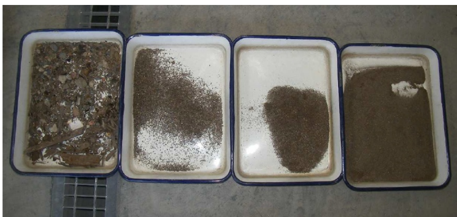
写真 10 ふるい下がれき残渣の各粒度範囲ふるい分け後の外観
