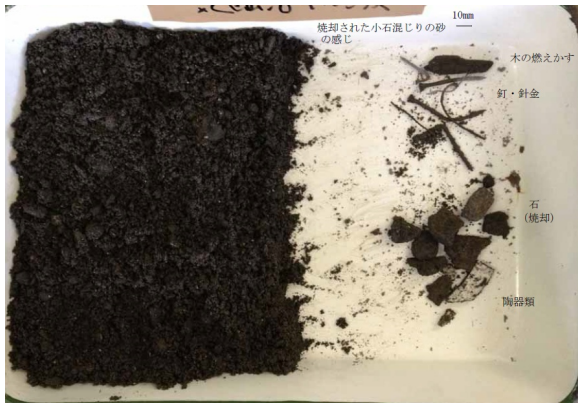
写真1 キルン灰(気仙沼)の混入不純物
