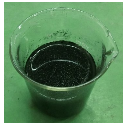
写真4 キルン灰の黒色浮遊物
