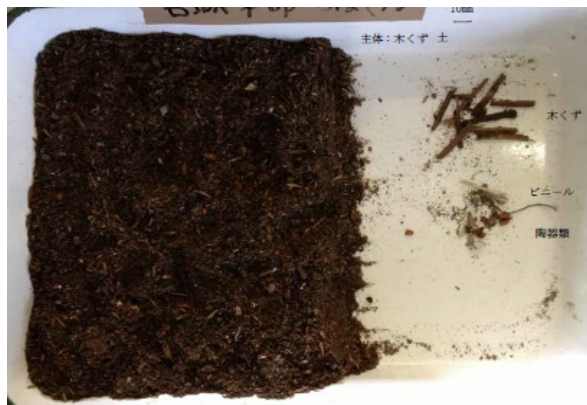
写真9 ふるい下がれき残渣(宮城東部)の混入不純物
