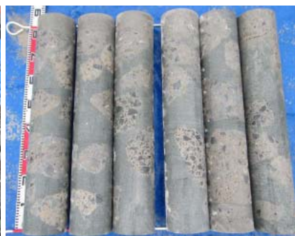
写真-6 \phi 150\text{cm} で採取したコア
