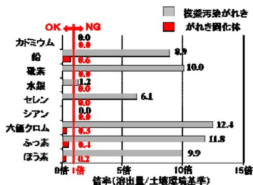
図3 セメント固化体の溶出試験結果
