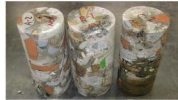
写真5 一軸圧縮試験供試体
