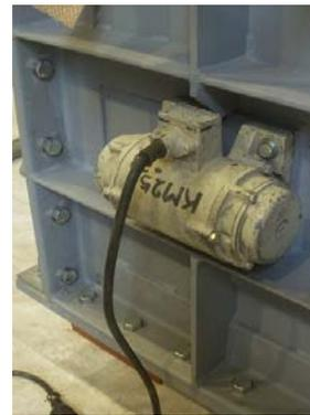
写真4 型枠バイブレータ
