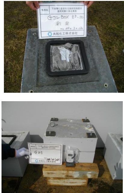
図 8 遮蔽性試験（実証試験現場）
