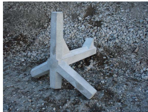
写真-5 石材（前面のみ）と中詰材にコンクリートがれきを使用したブランチブロックのモデル施工
