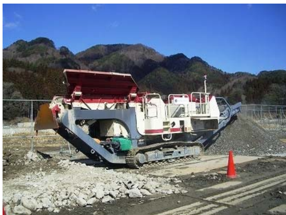
写真-2 実験に用いた移動式破碎機
