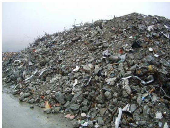
写真-1 実験に用いたコンクリートがれき
