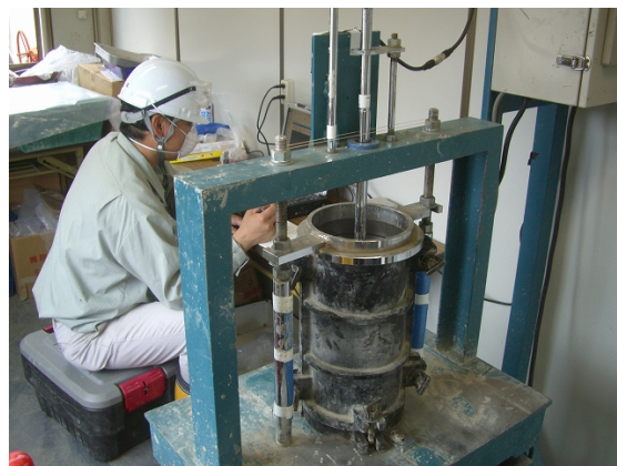
写真-3 締固め性試験の実施状況
