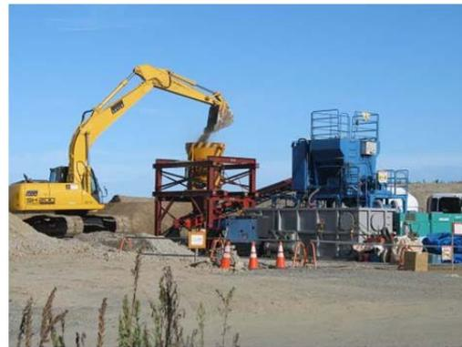
写真1 ガランダム工法製造プラント
