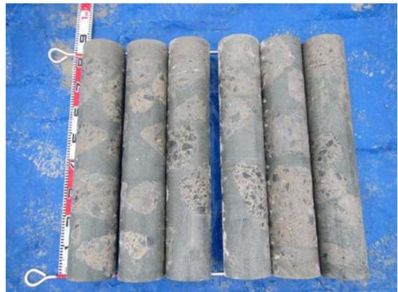
写真-8 ブロックより採取したコア供試体
