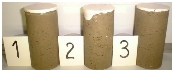
ボンテラン改良土の乾湿繰返し試験状況 (10 サイクル終了時、 W_0=105\% )
