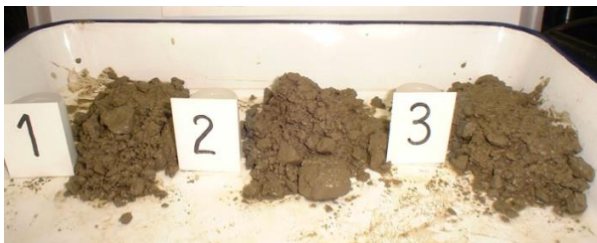
安定処理土の乾湿繰返し試験状況 (2 サイクル終了時、 W_0=105\% )
