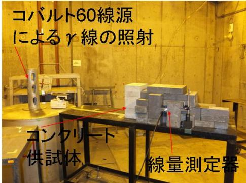
写真-3 遮へい性能比較試験状況
