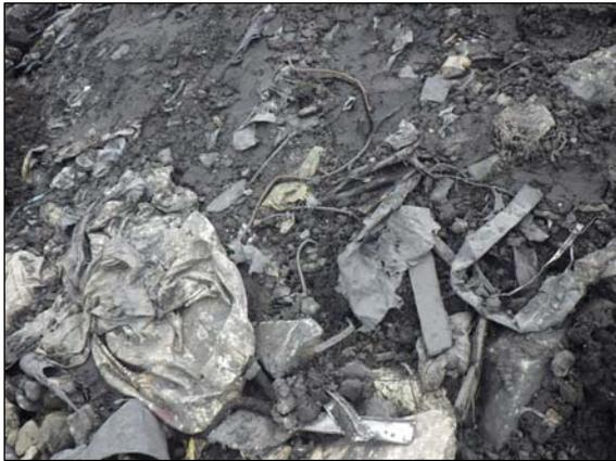
写真-3 高含水津波堆積土
