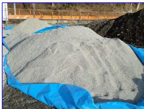
写真-14 コンクリートダスト (最大粒径 20mm)
