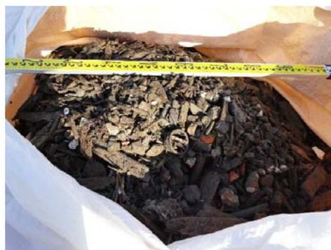
写真-16 混合くず (粒径 9.5mm 以上)
