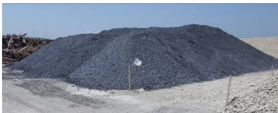
写真-2 主灰造粒固化処理物の仮置き状況
