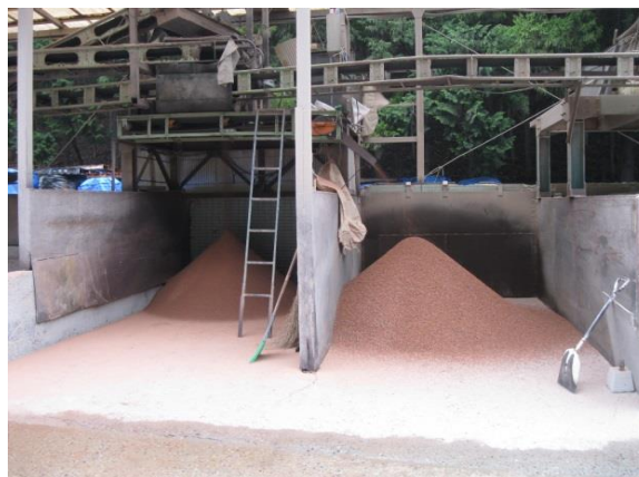
写真 3. 破碎・篩分加工後の状態
