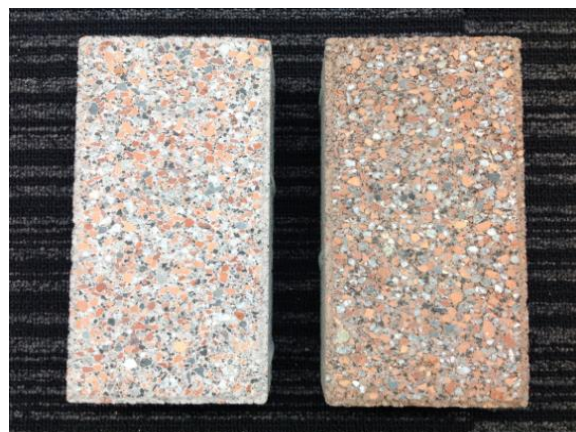
写真7. 表面を研磨加工した I L B (色の違いは顔料の有無による)
