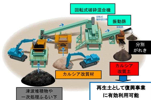
図1-1 カルスピン工法の概要図
