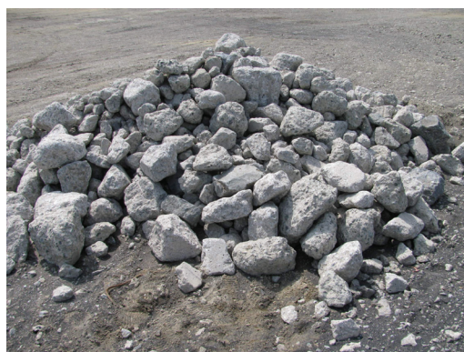
写真-7 小割りされたコンクリート廃材
