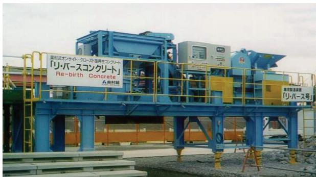
写真-1 設置撤去が容易な専用製造装置
