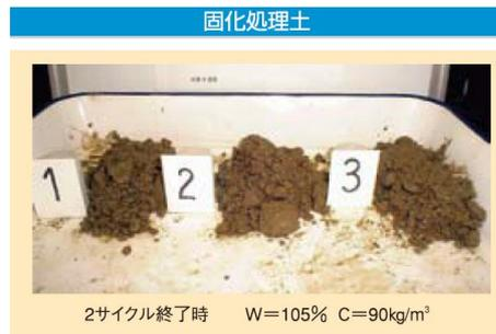
固化処理土は2サイクルで完全崩壊
