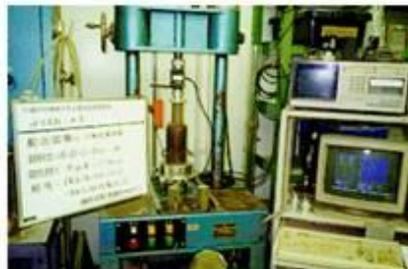
写真-3 一軸圧縮試験機
