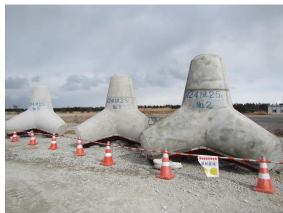
図-2 モルタル注入の様子と完成した消波ブロック
