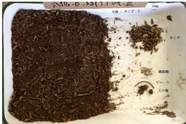
写真 6-1-2-7 ふるい下がれき残渣(気仙沼)の混入不純物
