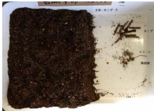
写真 6-1-2-9 ふるい下がれき残渣(宮城東部)の混入不純物
