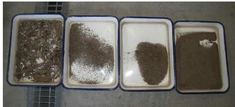
写真 9 ふるい下がれき残渣(宮城東部)の混入不純物
